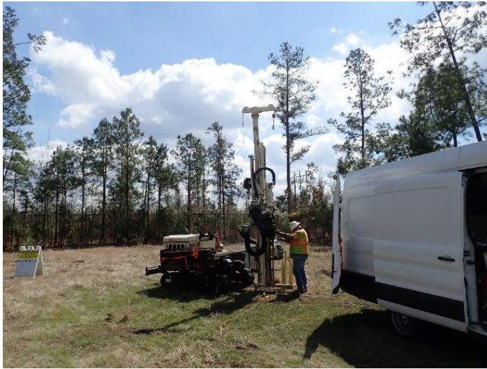
MiHPT Rig: Geoprobe 7820DT
